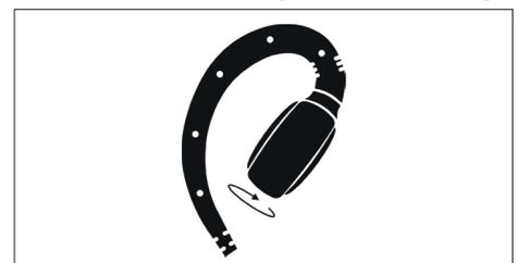
Abbildung 3: Drehbarer Ohrknopf
